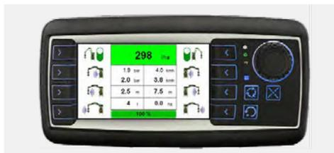
Durante il trattamento, il **PLC** visualizza i dati caratteristici di lavoro, quali velocità e pressione istantanee, ettari trattati, capacità residua del serbatoio, posizione dei bracci, sezioni attive.
